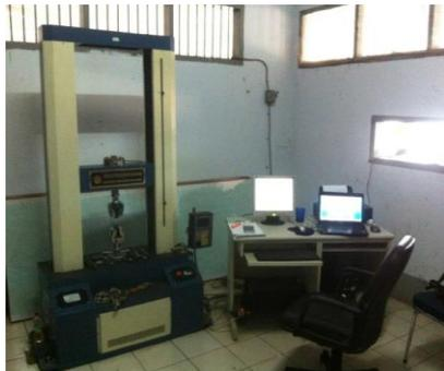
Gambar 1. Mesin Uji Tarik
