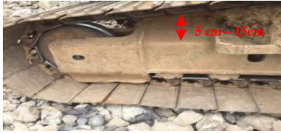
Gambar 7. Cara penyetelan kekencangan track link (Dokumentasi pribadi peneliti)
