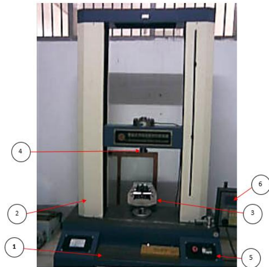
Gambar 6. Mesin uji tarik (dokumentasi pribadi).
