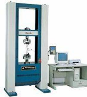
Gambar 5. Alat uji tarik dan uji bending batang G. Pengujian Kekerasan Rockwell
