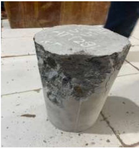
Gambar 1. Pengujian kuat tekan beton
