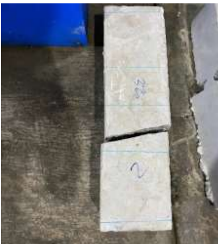
Gambar 3. Pengujian kuat lentur beton
