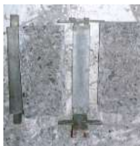
Gambar 5. Beton yang diuji kuat tarik belah.
