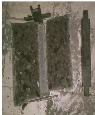
Gambar 6. Hasil uji Kuat Tarik Belah Beton
