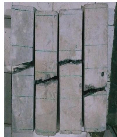
Gambar 7. Hasil uji Kuat Lentur Beton
