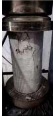
Gambar 1. Contoh pengujian kuat tekan beton
