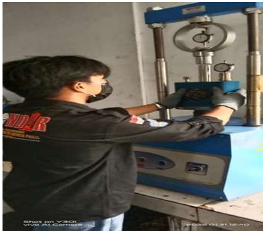
Gambar 3. Pengujian Benda Uji Menggunakan Marshall Test
