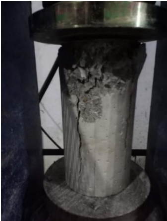
Gambar 4. Beton yang sudah diuji kuat tekan
