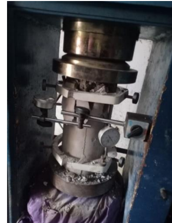
Gambar 6. Beton yang sudah diuji modulus elastisitas
