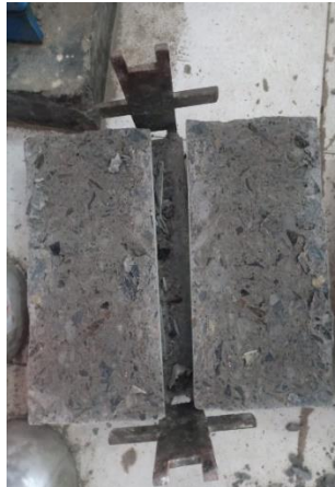
Gambar 5. Beton yang sudah diuji kuat tarik belah
