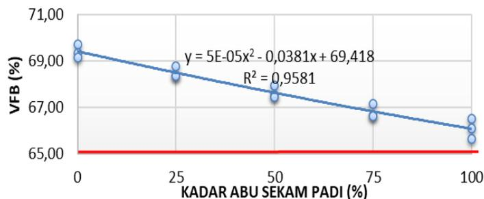
Gambar 6. Hubungan Kadar Abu Sekam Padi dengan VFB
