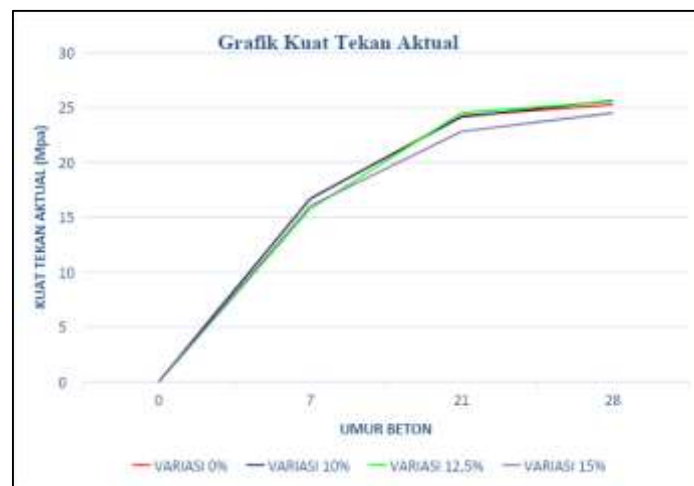
Gambar 4. Grafik Kuat Tekan Beton Berdasarkan Usia Beton
