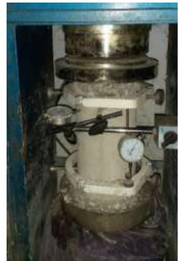
Gambar 6. Pengujian Modulus Elastisitas Beton
