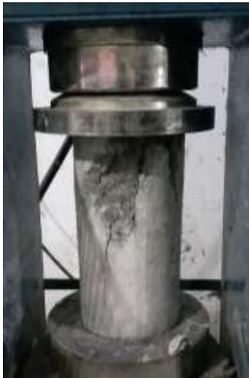
Gambar 4. Pengujian Kuat Tekan Beton
