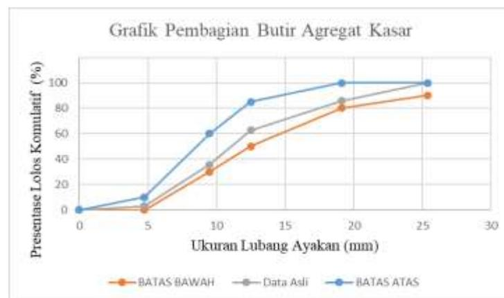
Gambar 4. Pembagian gradasi agregat kasar
