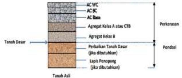
Gambar.2. Lapisan jalan perkerasan lentur
