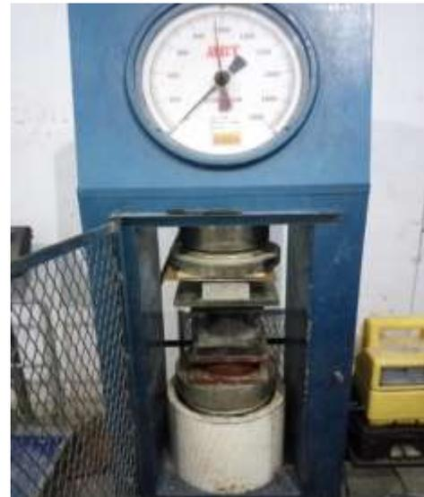
Gambar 5. Pengujian Kuat Tekan Bata Ringan
