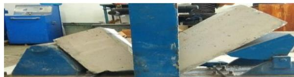
Gambar 10. Pengujian kuat lentur beton
