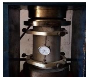
Gambar 11. Pengujian modulus elastisitas
