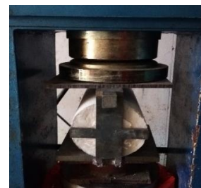
Gambar 8. Kuat tarik belah beton
