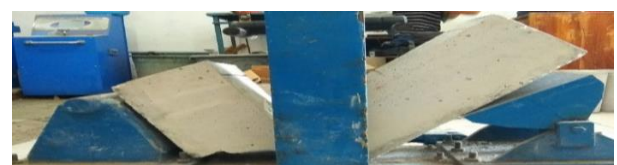
Gambar 9. Pengujian kuat lentur beton
