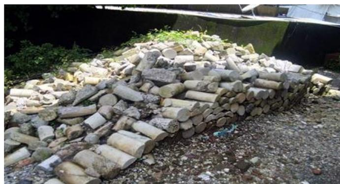
Gambar 1. Limbah Beton hasil buangan laboratorium
