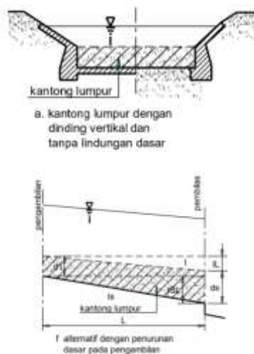
Gambar 4. Potongan melintang dan potongan memanjang kantong lumpur menunjukkan metode pembuatan tampungan
