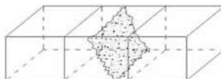
Gambar 3. Beton Patah pada Pusat 1/3
