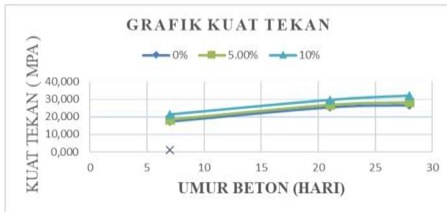
Gambar 7. Grafik hasil pengujian kuat tekan beton ( $f'c$ )
