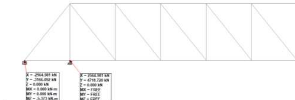
Gambar 6. Hasil Reaksi Tumpuan dengan program STAAD
