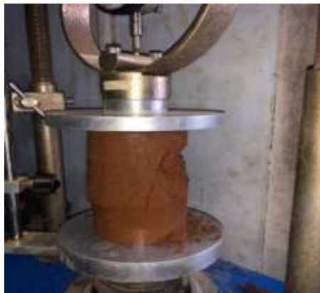
Gambar 5. Benda Uji Kuat Tekan Bebas
