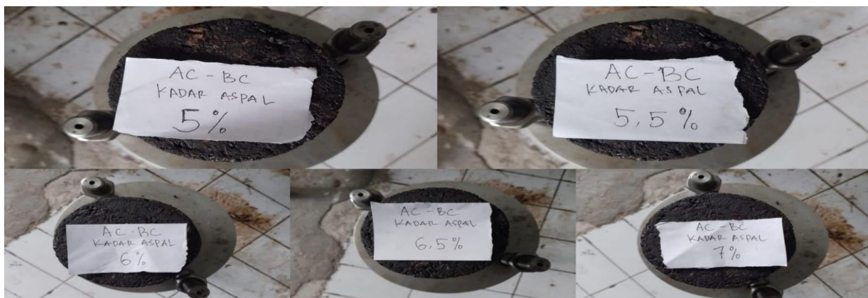
Gambar 2. Benda Uji menggunakan kadar aspal 5-7%
