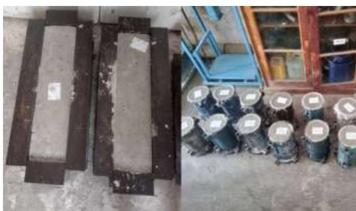
Gambar 1. Benda Uji Silinder dan Balok
