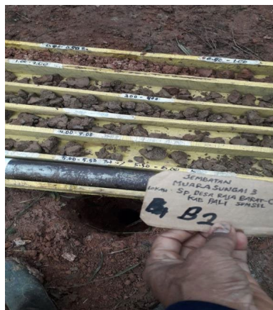
Gambar 4. Hasil Pengeboran Tanah pada Titik Bor 2
