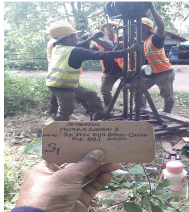
Gambar 2. Penyelidikan Tanah dengan Uji Sondir
