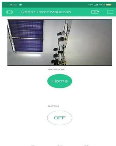
Gambar 3.3 Rancangan Tampilan Pada Mode Otomatis
