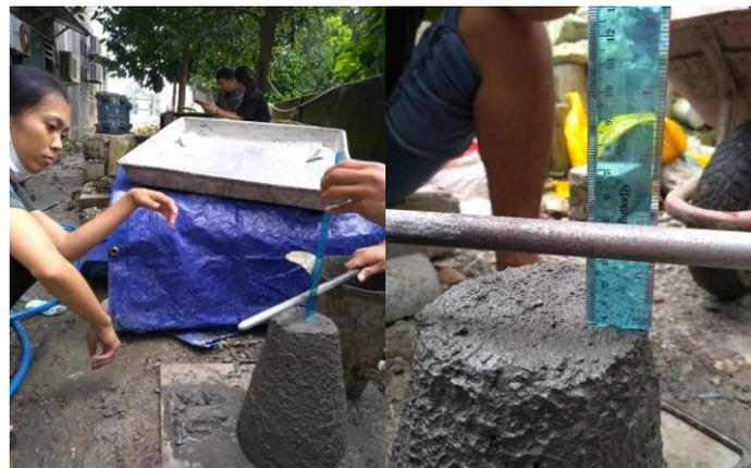
**Gambar 8.** Pengujian *Slump Test*
