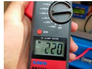
Pengukuran tegangan AC
