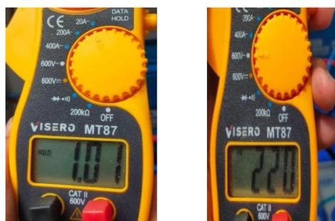
Pengukuran tegangan Pengukuran Arus
