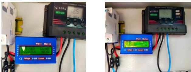
**Gambar 21. Pengukuran tegangan dan arus Panel surya ke SCC**
