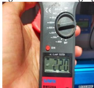
Pengukuran tegangan AC
