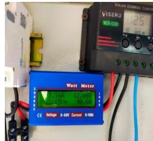
Pengukuran arus dan tegangan DC
