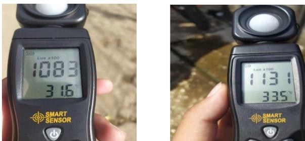
**Gambar 22. Pengukuran intensitas sinar matahari**
