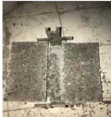
Gambar 6. Beton yang telah diuji kuat tarik belah.
