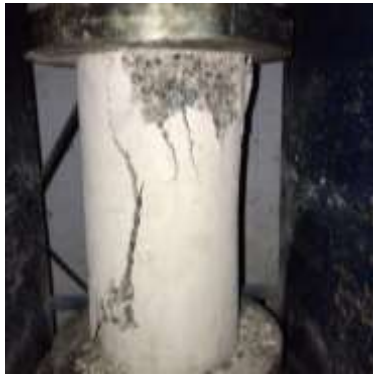
Gambar 5. Beton yang telah diuji kuat tekan.
