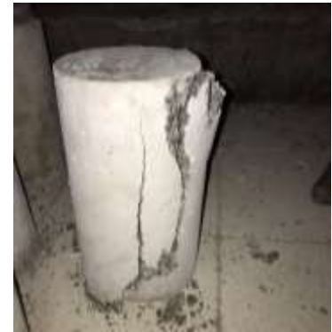
Gambar 7. Beton yang telah diuji modulus elastisitas
