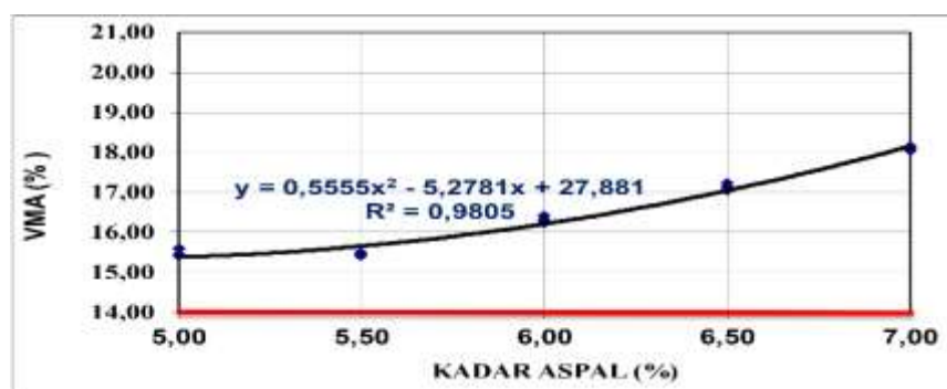
Gambar 8. Hubungan Antara Kadar Aspal dan VMA SMA Halus
