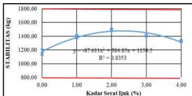
Gambar 2. Grafik hubungan variasi serat ijuk dengan stabilitas campuran AC-WC
