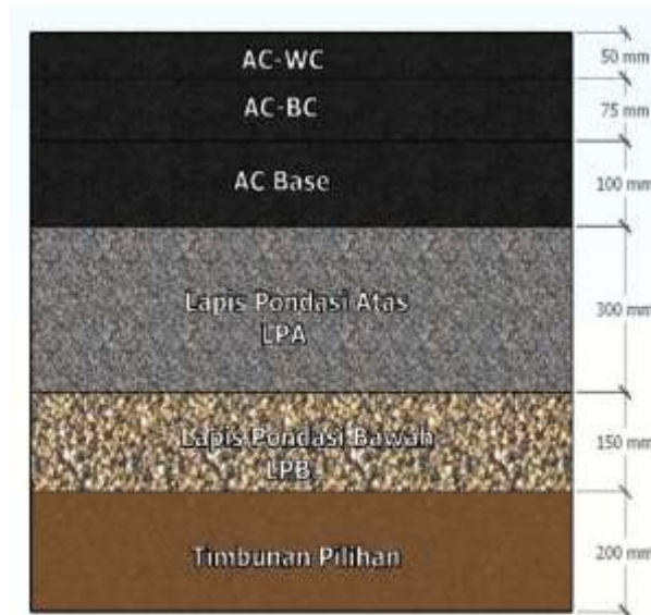
Gambar 3. Skema Tebal Perkerasan berdasarkan MDPJ 2024
