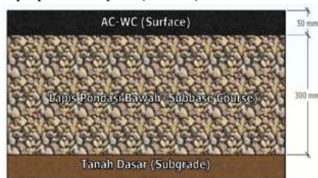
Gambar 2. Skema Tebal Perkerasan berdasarkan Circly 7.0
