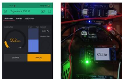
**Gambar 11.** Pengujian Perangkat Chiller Mati Otomatis
